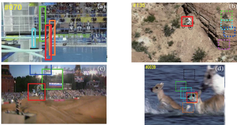
图1 经典跟踪算法中的跟踪漂移。(a)文献[9]算法;(b)文献[14]算法;(c)文献[15]算法;(d)文献[16]算法
