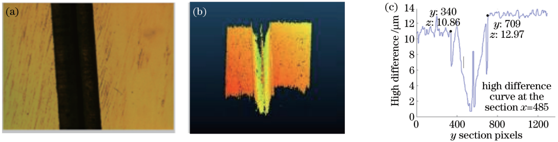
图 13 标准台阶测量结果。(a)图像序列中的一幅图像;(b)三维点云数据;(c)某一截面的点云分布
