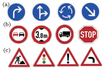
图 3 交通标志的 3 个示例。(a)指示;(b)禁止;(c)警告
