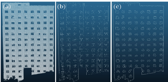
图 7 边界的提取。(a)原始点云;
