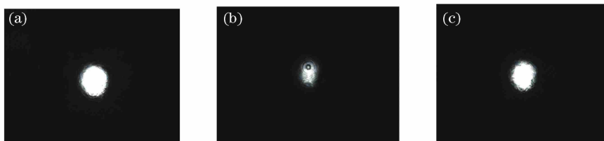
图 10 CCD 采集的光斑图。(a)初始光斑;(b)畸变光斑;(c)校正后的光斑
