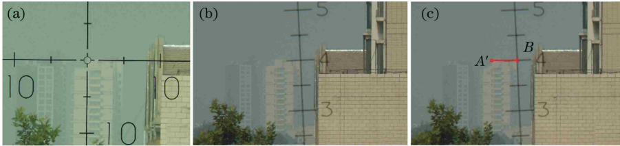
图 8 两根光轴不平行时的采集图像。(a) O_1 采集图像;(b) O_2 采集图像;(c) O_1 与 O_2 分划中心偏差示意图
