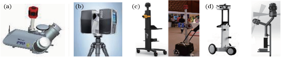
图 1 3D 数据采集系统。(a)车载系统;(b)固定式扫描仪;(c)手推车式采集系统;(d)背负式采集系统
