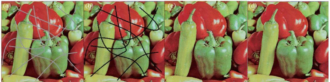
图 6 划痕图像修复效果图。(a)原始划痕图像;(b)掩模图像;(c) BSCB 模型修复结果;(d)粗糙数据推理修复结果
