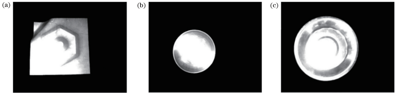
图 2 三个具有高反射特性的实验物体。(a)金属块;(b)不锈钢表面 1;(c)不锈钢表面 2
