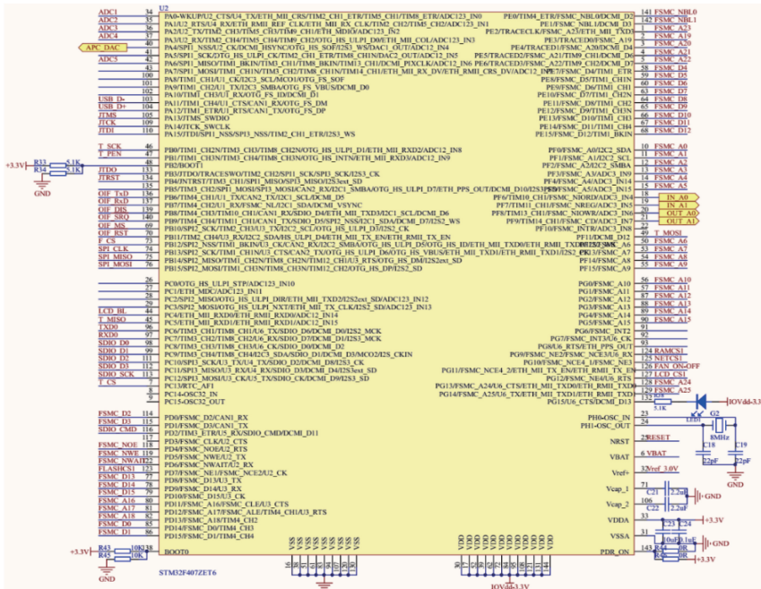
图 2 处理器及其外围电路接口
