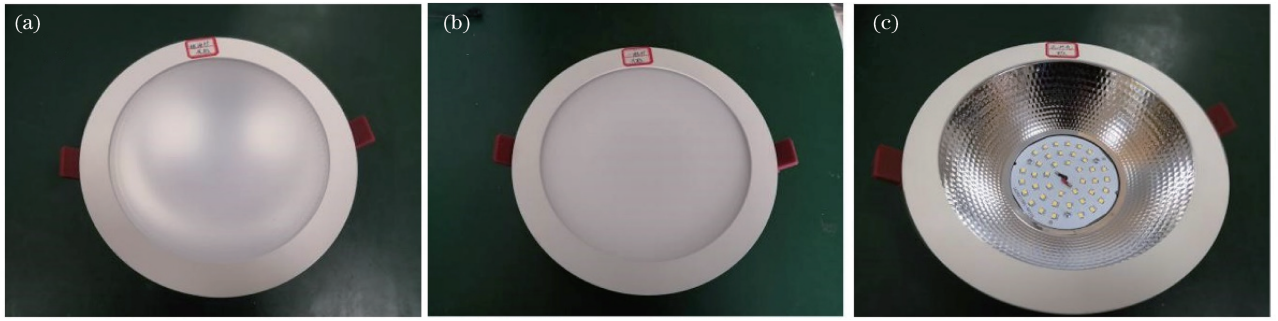
图 15 CD 纹微结构扩散板和普通扩散板对比图。(a)微结构扩散板;(b)一般扩散板;(c)无扩散板
