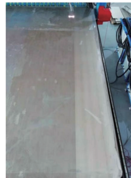
图11 激光清洗大面积钛合金轧板
