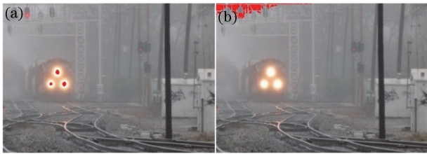
图 2 两种算法选取估计大气光值的像素点的对比图。
