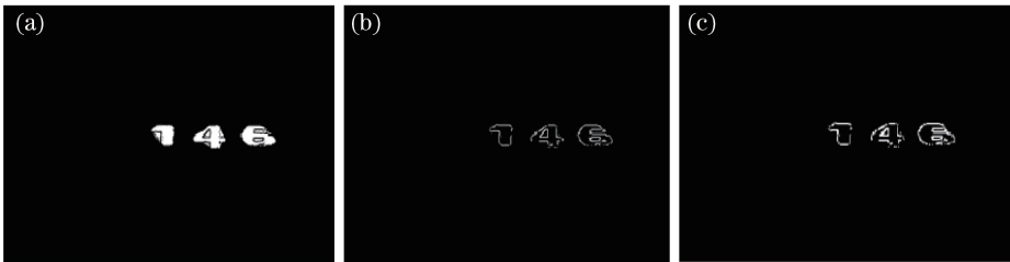
图 3 字符边缘增强过程。(a)字符候选区域;(b)字符候选域的边缘提取图;(c)字符的边缘增强图
