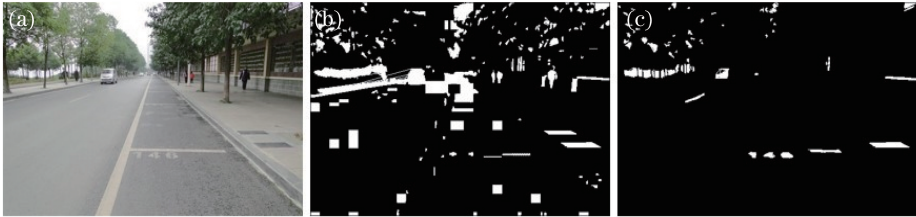
图 2 本文提取方法与传统 MSER 提取方法对比。(a)某停车位数字编号原始图;(b)传统 MSER 提取效果图;(c)对 S 通道进行 MSER 提取的效果图
