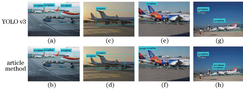
图9 不同遮挡程度的飞机检测对比实验。(a)(b)遮挡比例接近于20%;(c)(d)遮挡比例接近于60%;(e)(f)有明显颜色特征、遮挡比例接近于60%;(g)(h)遮挡比例接近于80%
