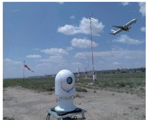
图 12 三维激光测风雷达在机场中的应用 [1]
