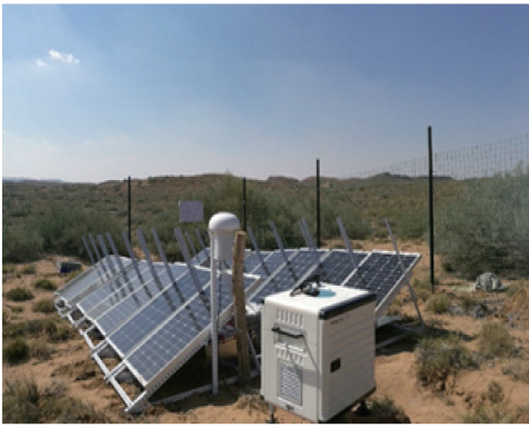
图 13 民用低空激光多普勒测风雷达 Molas B300 在风电行业中的应用 [39]
