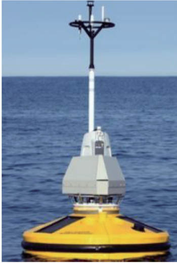
图 8 ZephIR 激光多普勒测风雷达的应用 [35]
