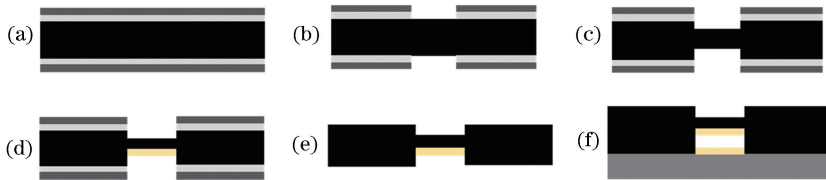
图 4 传感头制作工艺流程图。(a)氧化沉积保护层;(b)光刻;(c)刻蚀;(d)镀膜;(e)去除保护层;(f)键合
