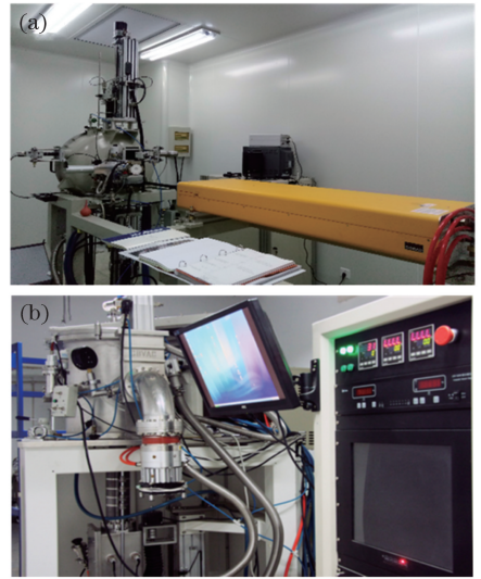
图 5 山东大学晶体光纤生长设备。(a) 激光加热基座晶体生长炉；(b) 微下拉晶体生长炉
