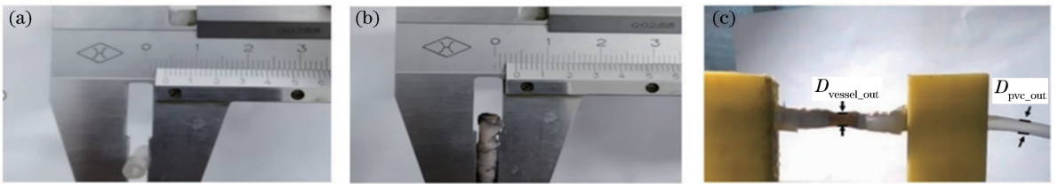
图 4 血管外径测量图。(a)游标卡尺测量 PVC 管外径;(b)游标卡尺测量血管外径;(c)血管模型构建
