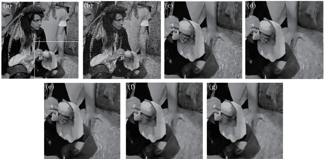
图4 图像Male在噪声密度范围为50的椒盐噪声下去噪细节效果图比较,其中(c)~(g)为图(a)的框图细节部分。 (a) Male图像原图;(b)噪声密度为50的椒盐噪声图像;(c)本文算法结果;(d) WNNM结果;(e) WSNM结果; (f) BM3D的结果;(g) RM的结果
