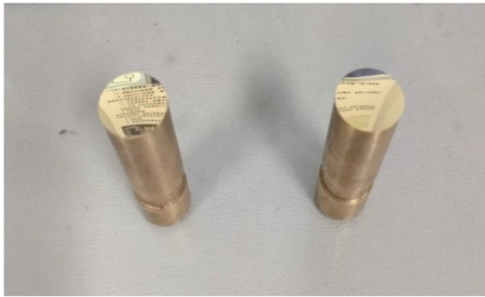
图4 实际加工的非球面工件 Fig. 4 Actual processing aspherical work piece
