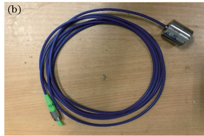
图6 EFPI传感器。(a)结构示意图;(b)实物 Fig. 6 EFPI sensor. (a) Structural diagram; (b) photograph
