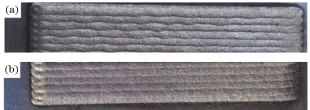
图 3 33% 搭接率下熔覆层宏观形貌对比。
