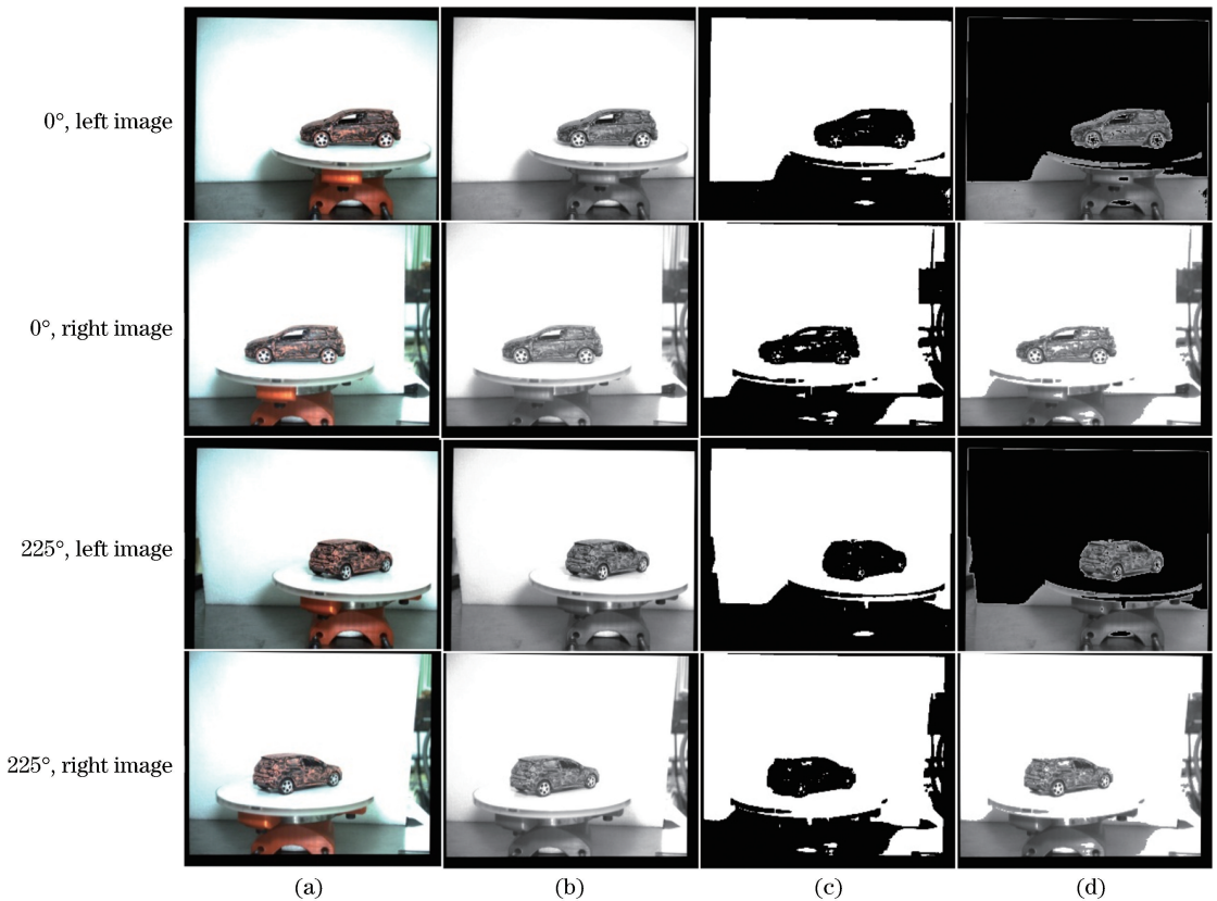
图 11 采用传统方法三维重构图像预处理过程图。(a)原图;(b)背景抑制图;(c)分割图;(d)叠加图
