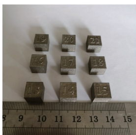
图 1 SLM 成形的 IN738 块状试样件
