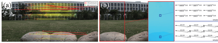
图 3 特征点匹配和光流计算结果。(a)特征点匹配;(b)光流计算
