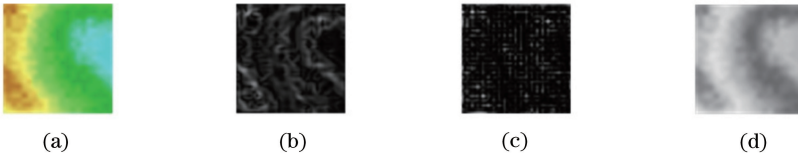
图8 核尺寸 5 \times 5 不同卷积核运算结果。(a)原图;(b) Sobel 算子处理;(c) Laplace 算子处理;(d)高斯算子处理
