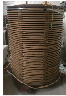
图 6 改造变压器绕组 Fig. 6 Adapted transformer windings
