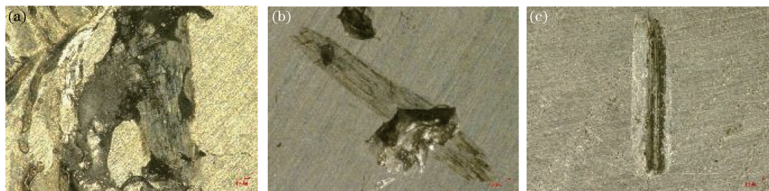
图 8 不同试样熔覆层及基材表面的磨损形貌。(a) 试样 1; (b) 试样 3; (c) 基材
