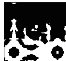
图 10 图 8(b)的基本全局阈值法和大津法分割结果 Fig. 10 Segmentation results of Fig. 8(b) using basic global threshold method and Otsu method 示。与上组结果类似,灰度拉伸后,可看出基本全局阈值法和大津法仍然不适合分割该图像。
