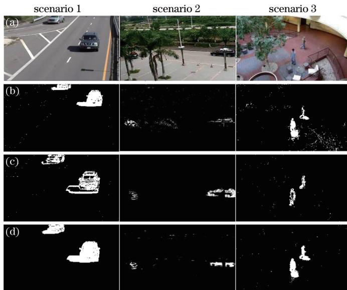
图2 不同场景检测结果的比较。(a)原始视频序列;(b)基于卡尔曼滤波的背景差分法;(c)文献[13]方法;(d)本文方法
