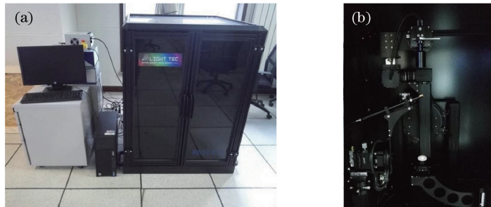
图 1 REFLET 散射测量仪。(a)整体结构;(b)光学工作台及暗室
