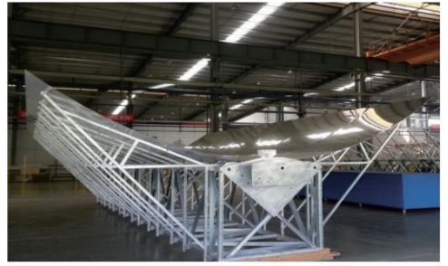
图 7 大型槽式太阳能反射镜面测量场
