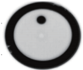
图4 双包层单模 TDF 剖面图
