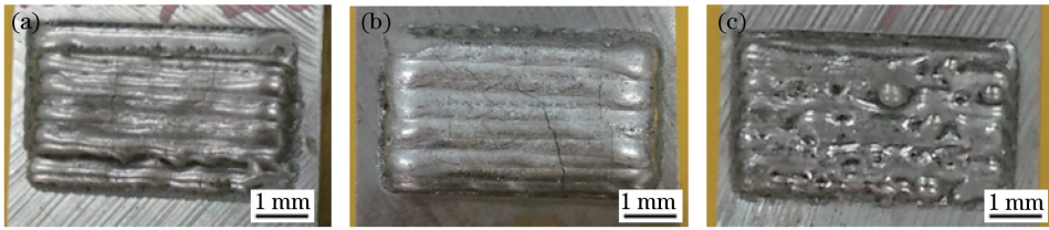
图2 不同扫描速度下激光快速成型 Fe 基合金样品的表面形貌。(a) 400 \text{ mm}\cdot\text{min}^{-1} ; (b) 600 \text{ mm}\cdot\text{min}^{-1} ; (c) 1000 \text{ mm}\cdot\text{min}^{-1}
