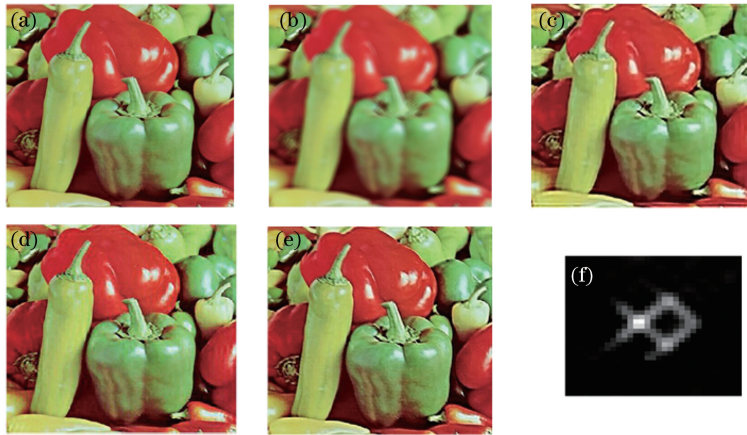
图3 模糊图像 peppers(K2)的盲复原对比结果。(a)清晰图像;(b)模糊图像(K2); (c)文献[9]方法;(d)文献[19]方法;(e)本文方法;(f)本文方法估计模糊核
