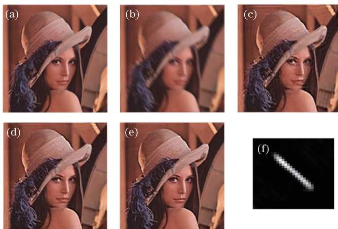
图 2 模糊图像 Lena( K1 )的盲复原对比结果。(a)清晰图像;(b)模糊图像( K1 );(c)文献[9]方法;(d)文献[19]方法;(e)本文方法;(f)本文方法估计的模糊核
