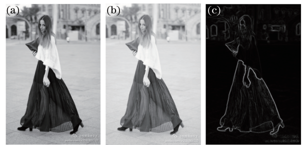
图 4 特征提取图。(a) 灰度化图; (b) 伽马校正图; (c) 梯度图
