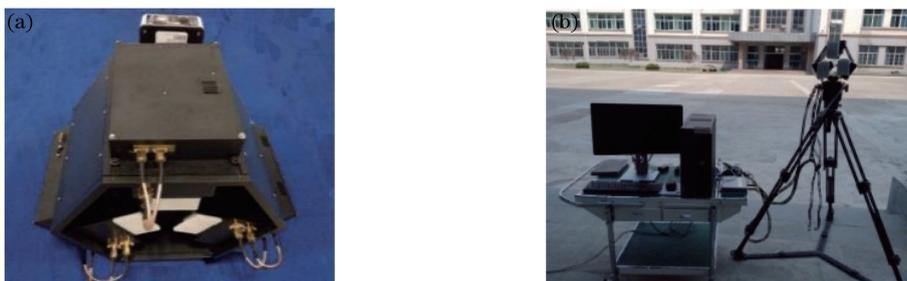
图 1 分孔径同时式高光谱偏振成像系统的(a)实物图和(b)室外实验图
