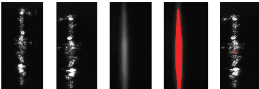
图 5 激光光带条纹及其处理结果图
