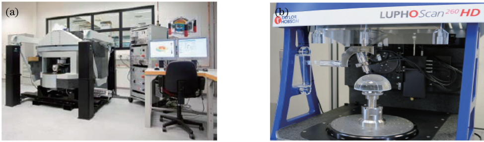
图9 非接触式扫描测量仪。(a) Nanomefos;(b) Lumphoscan
