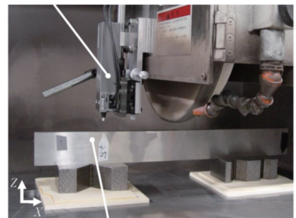
图5 大口径非球面磨削在位测量装置 [28]
