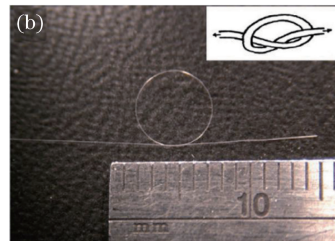
图 21 (a)采用筛选和未筛选 YAG 粉体制备的光纤的显微照片;(b)打环后的 YAG 光纤实物照片
