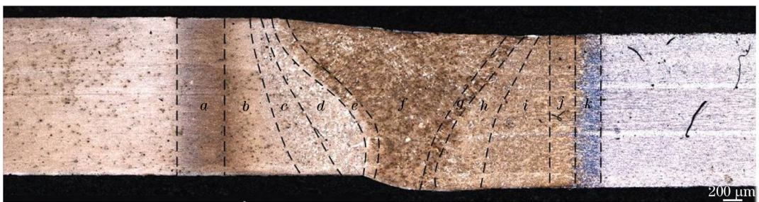
图6 焊接接头横截面宏观形貌及区域划分
