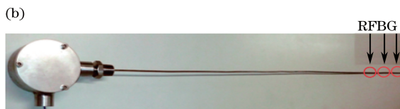
图8 钢管封装再生光纤光栅传感器。(a)机械模型;(b)传感器照片
