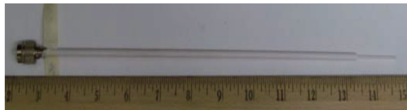
图6 陶瓷管式封装再生光纤光栅传感器照片
