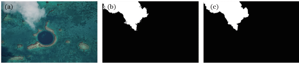
图 2 云检测获取云区掩模。(a)原图;(b)初步云检测掩模;(c)形态学开运算结果
