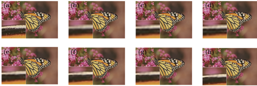
图 7 3 倍放大比例下, Set14 测试集中 monarch.bmp 经处理后的整体及局部效果对比图。(a) 真实图像; (b) Bicubic/29.43 dB; (c) SRCNN/32.39 dB; (d) FSRCNN/32.44 dB; (e) VDSR/34.51 dB; (f) DRRN/34.68 dB; (g) 本文 SDN/34.53 dB; (h) 本文 CWTDN/34.82 dB
