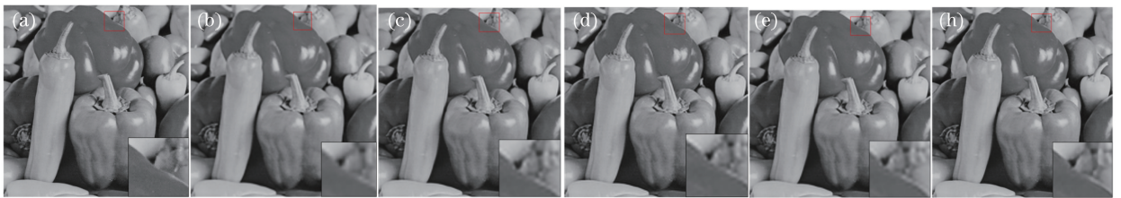
图 8 Set 14 中的 pepper 重建结果比较。(a)原图;(b) BI/32.38 dB;(c) ScSR/33.32 dB; (d) SRCNN/32.08 dB;(e) SRCNN-Ex/33.30 dB;(f)本文方法/34.57 dB
