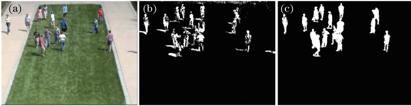
图 6 阴影实验结果对比图。(a)原图像序列;(b) Vibe 算法;(c)改进方法
