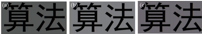
图 6 文字图像的测试效果。(a) RGB;(b)常规算法 RGBW;(c)本文算法 RGBWRGB
