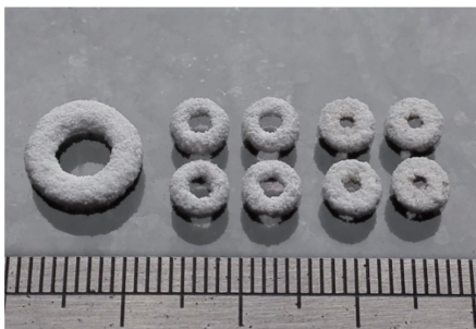
图 3 激光选择性烧结制备的封接玻璃预成型体
