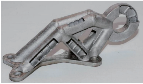
图 12 航天转轴结构组件 [44]
