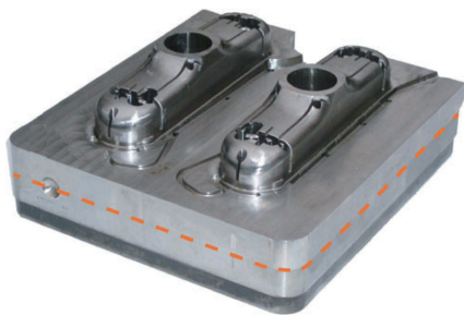
图 21 SLM 制造的压铸模具 [53]
