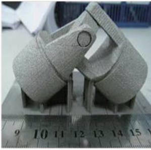
图 23 SLM 成型的免组装万向节 [57]
